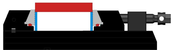
Para trabajos en piezas delgadas se pueden usar las bocas con escaló, para ello es necesario eliminar el efecto descendente. Si no se bloquean las bocas y la pieza puede salir mal.
