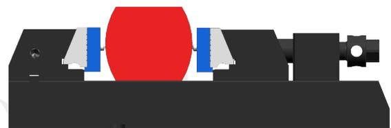
En piezas en bruto, forja, fundición, oxicorte etc. Utilizar prisioneros de empuje o bocas con pinchos. Mejora el amarre y garantiza la exactitud de los primeros fresados.
